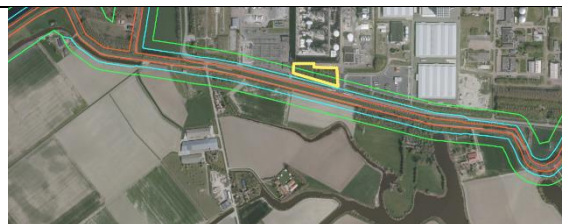
Figuur 3 keurzones waterkering binnendijk
