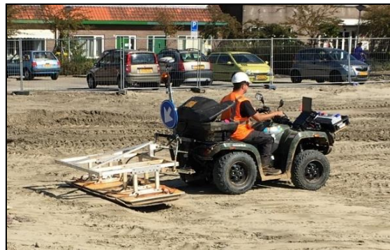
De 3D grondradar achter een quad
