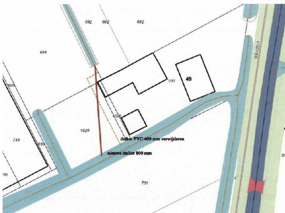
Afbeelding 6, locatie duiker watersysteem
