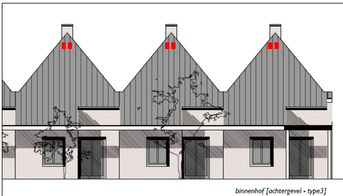
Figuur 8: Situering gierzwaluwpannen (rode vlakken) in de nieuwbouw ter hoogte van het voorm. dorps huis. Bron: KAW 2011.
