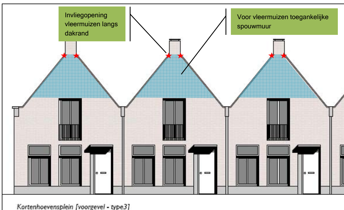
Figuur 7: Situering verblijfplaatsen en invliegopeningen voor vleermuizen in de nieuwbouw ter hoogte van het voorm. dorpshuis. Bron: KAW 2011.
