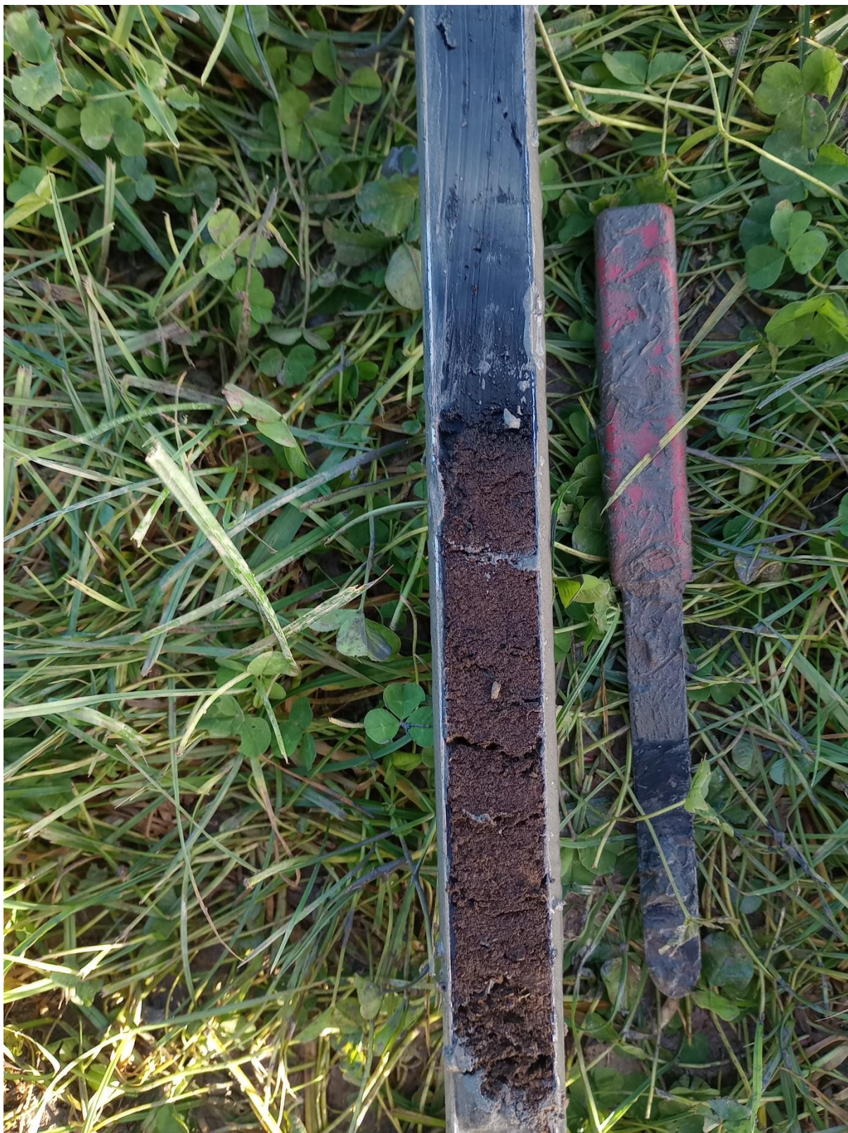
Figuur 12. Foto van de erosieve overgang van dijkdoorbraak-/overstromingsafzettingen naar Hollandveen (boring 3, circa 345-370 cm -mv)
