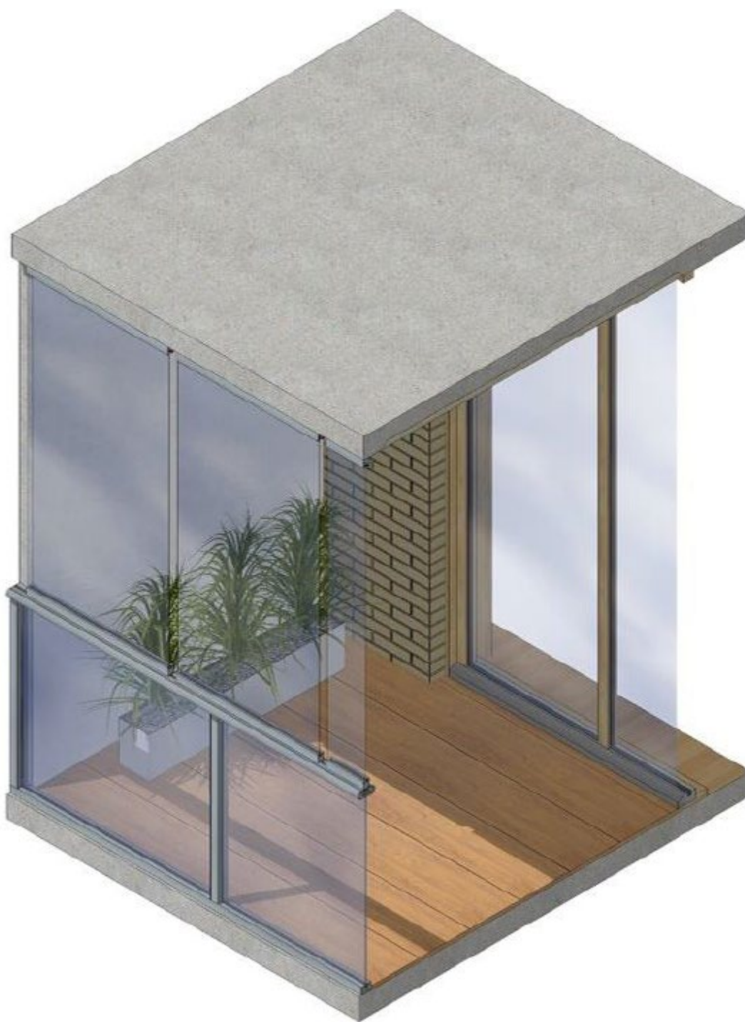
Verglaasde loggia: weergave van balkonverglazing in gesloten en open toestand, geluidreductie tot 9 dB op achterliggende gevel (bron: DGMR)
