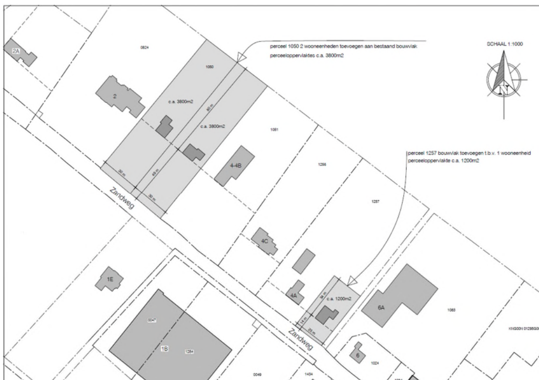
Figuur 1.2. Situatietekening 3 bouw kavels. Bron: Kostenbouwadvis, 2023.
