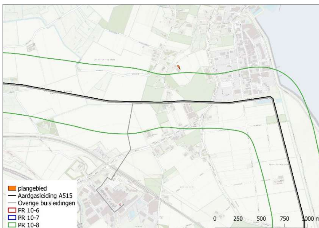
Figuur 3. Plaatsgebonden risicocontour aardgasleiding A515
