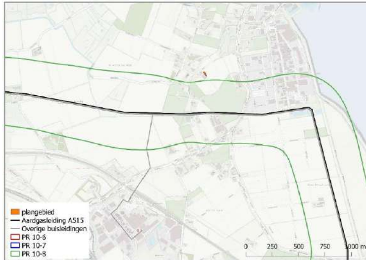
Figuur 5 Plaatsgebonden risicocontour aardgasleiding A515
