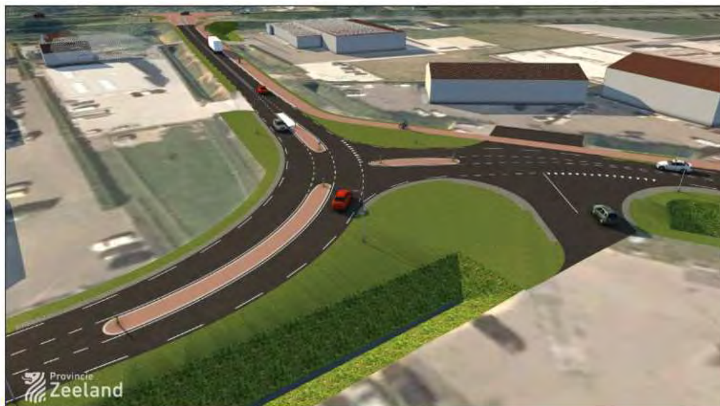
Kruispunt Molendijkseweg - Olzendepolder: voorrangskruispunt binnen de bebouwde kom. De doorgaande rijrichting op het kruispunt wordt Olzendepolder – Molendijkseweg, richting Molendijk. Het verkeer in de richting Olzendepolder-Molendijkseweg krijgt voorrang op verkeer van en naar de Korringaweg. (bron: www.zeeland.nl )
