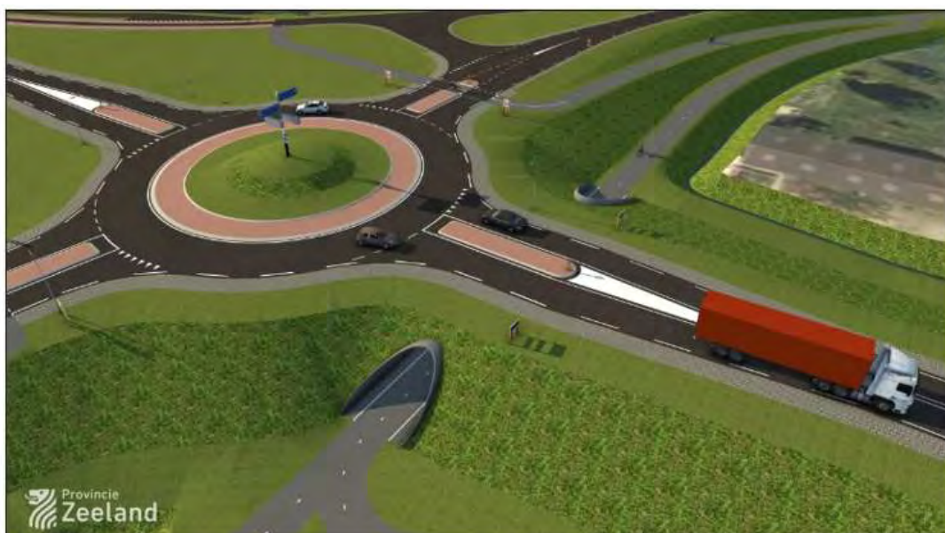
Fietstunnel rotonde Olzendedijk: aan de oostzijde van de rotonde Olzendedijk/Zanddijk/Molendijk komt een fietstunnel, die het fietspad Molendijk met Olzendepolder. Hierdoor kunnen (schoolgaande) fietsers nu nog veiliger fietsen vanuit Yerseke naar Oostdijk/Krabbendijke. (bron: www.zeeland.nl )
