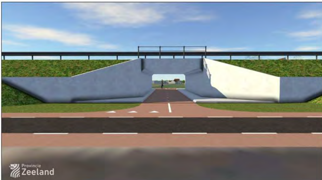
Fietstunnel Grintweg: de oversteek voor fietsers ter hoogte van de Grintweg komt te vervallen en wordt vervangen door een fietstunnel. De aansluiting van de Grintweg op de Zanddijk wordt vervangen door een nieuwe aansluiting op de aan te leggen parallelweg langs de Zanddijk. (bron: www.zeeland.nl )
