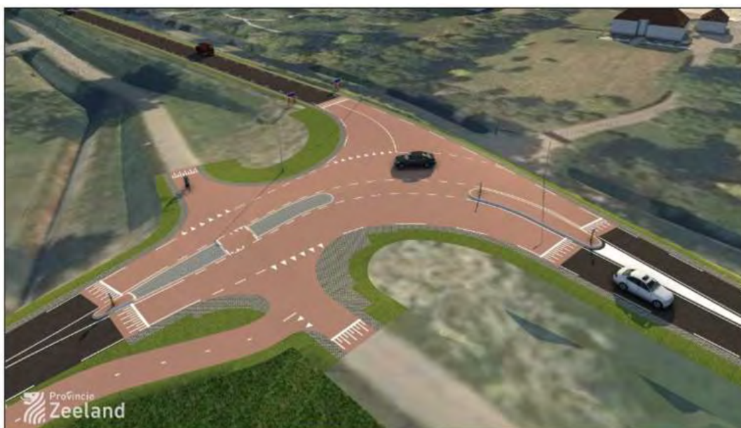
Kruising Molendijkseweg/Molendijk: de vorm van het kruispunt wordt aangepast, zodat Molendijk richting Yerseke - Molendijkseweg de doorgaande rijrichting wordt. Vanuit de parallelweg wordt een verplichte rijrichting voor vrachtauto's richting de Molendijkseweg ingesteld. (bron: www.zeeland.nl )
