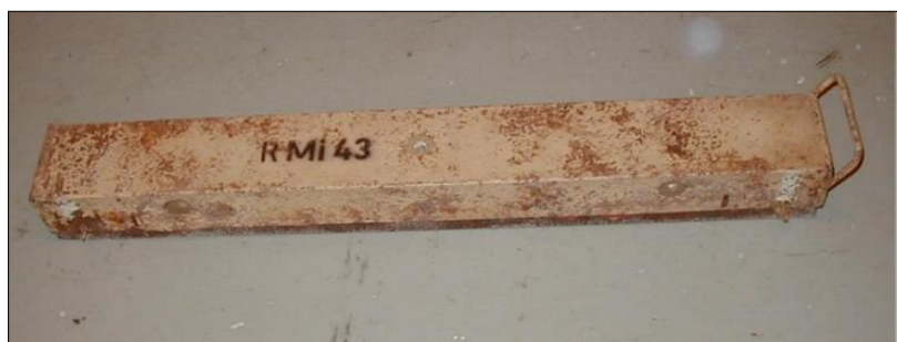
Duitse anti-tank mijn: Riegelmine 43
