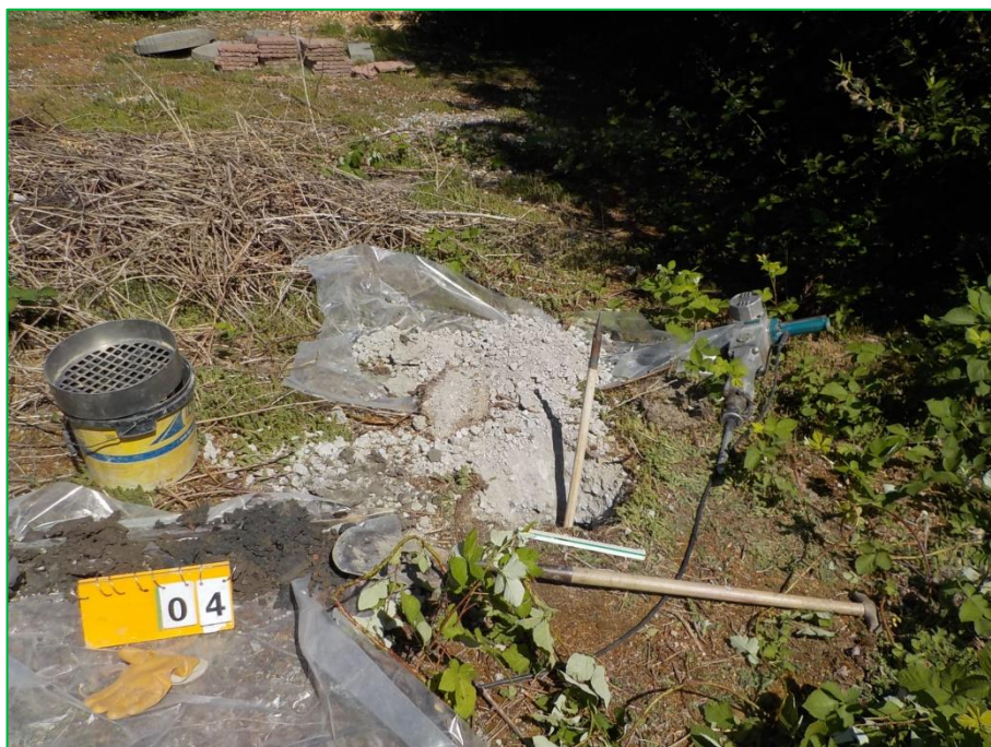
Foto 6. Opgeboord en opgegraven materiaal PG04
