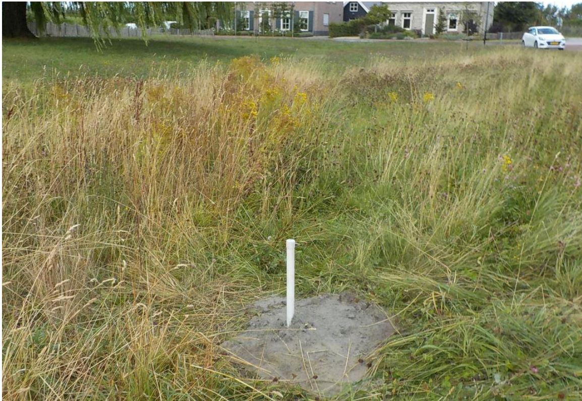
Foto 2: Peilbuis P27 geplaatst in de wadi binnen het bebouwd gebied.
