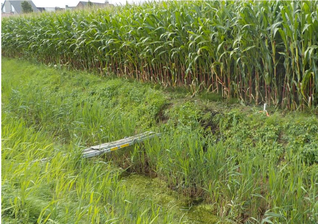
Foto 3: Peilbuis P11 geplaatst aan de slootkant.
