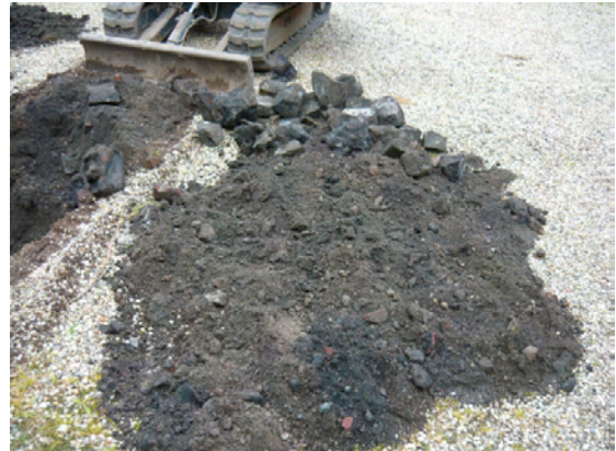
Foto 41 SL02 sterk puin- en steenhoudend grond
