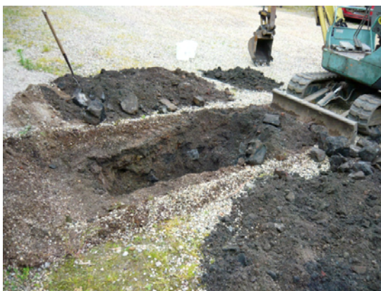
Foto 40 SL02 sterk puin- en steenhoudend grond
