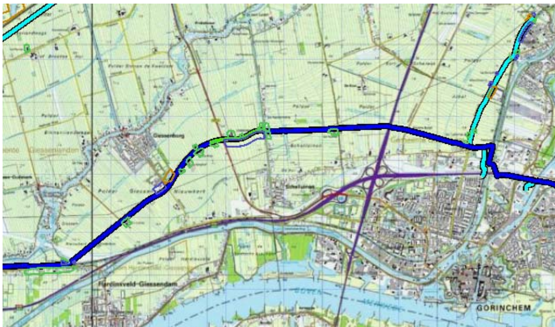
Figuur 5.8 Kilometer leiding behorende bij de maximale overschrijding van de FN-curve voor W-528-01 in de toekomstige situatie
