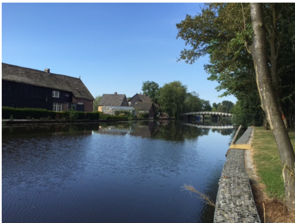
Figuur 3 Aan de zuidzijde van de planlocatie grenst de Giessen. Langs de Giessen is een relatief hoge en steile oeverbescherming in de vorm van steenkorven aangebracht.
