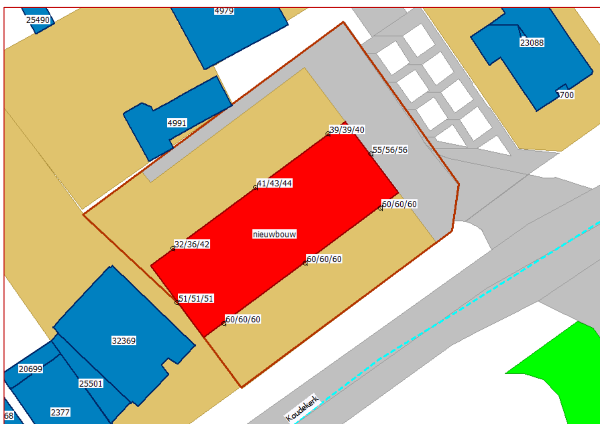
Figuur 4.3: Rekenresultaten na cumulatie van geluid vanwege wegverkeerslawaaï, zonder aftrek.
