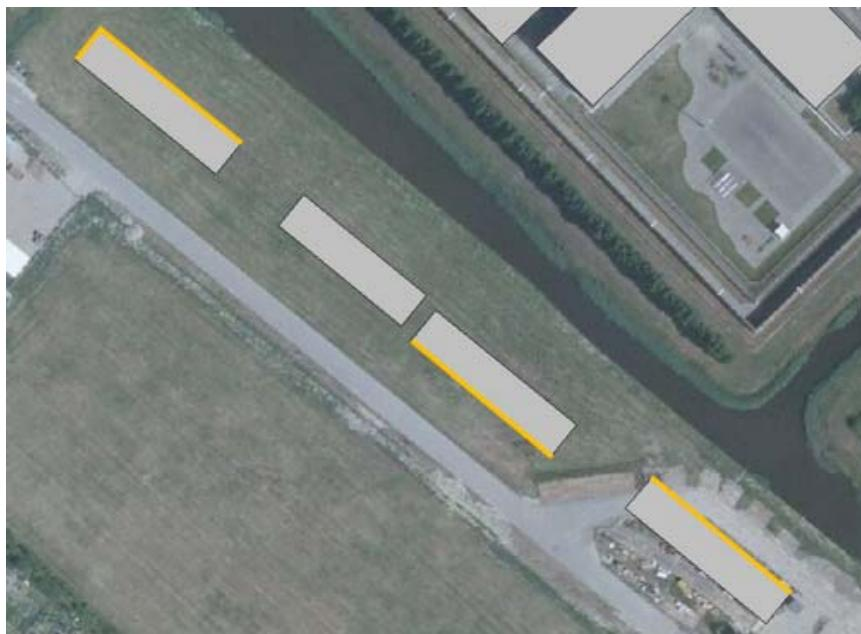
Figuur 5.1: Overschrijdingen geluidbelastingen aan de gevels (aangegeven in het oranje)
