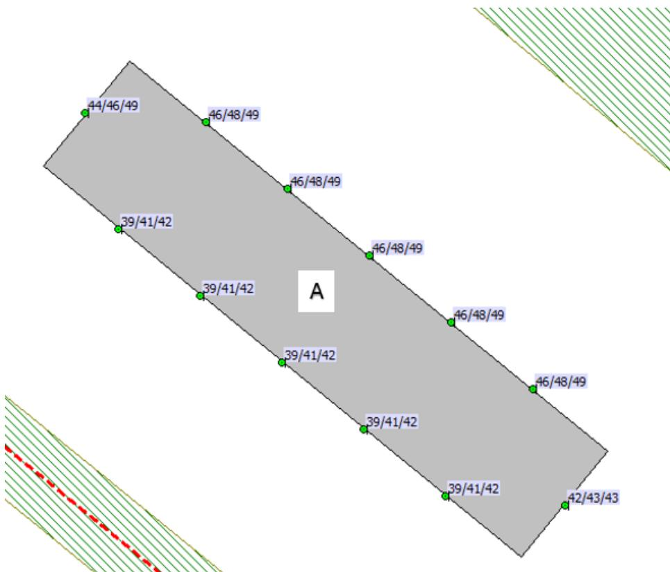
Figuur 4.2: Berekende geluidbelasting t.o.v de N57 (blok A)
