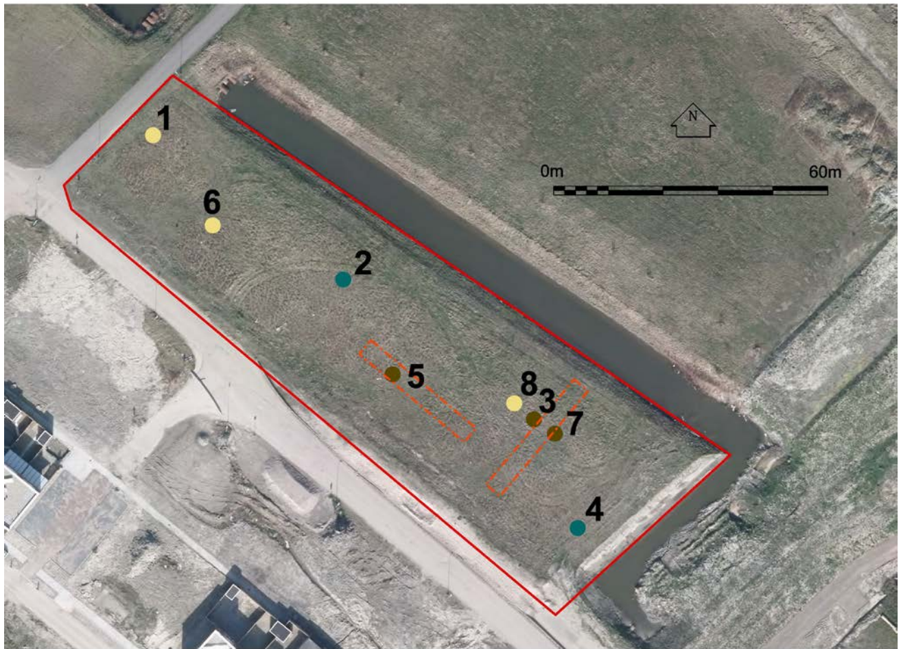
Fig. 4 – Overzicht plangebied met resultaten booronderzoek en de locatie van de proefsleuven. De bruine punten geven het intacte Hollandveen aan, de gele punten de kreekafzettingen en de groene punten de zones met moernering.
