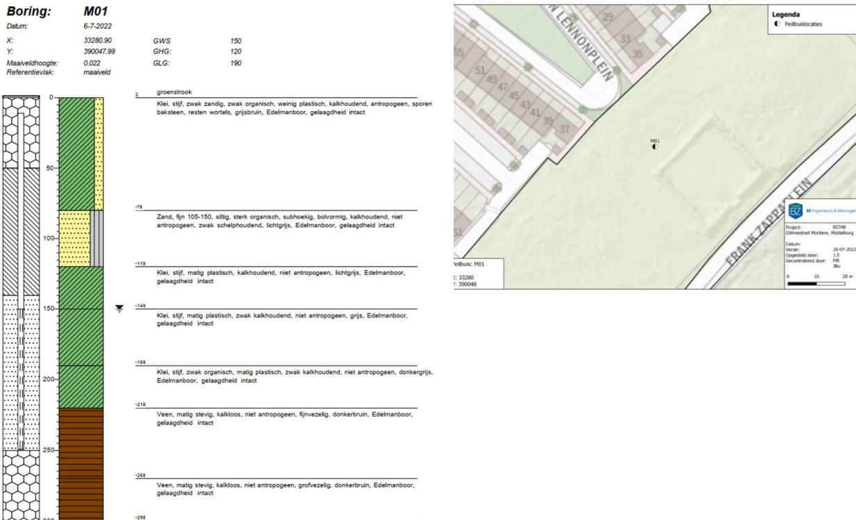
Figuur 3 Boring M01 met peilbuis in fase 6B: klei, zand, klei en veen tot een diepte van NAP -3,0 m.
