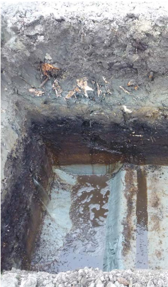
Fig. II - 4 Links een foto van het bodemprofiel van proefsleuf WP 3 met een recent verrommelde bovenkant, een dun pakket klei van het Laagpakket van Walcheren en een relatief dun pakket Hollandveen met veraarde top. Onderin de slappe klei van het Laagpakket van Wormer. Rechts een foto van het bodemprofiel van proefsleuf WP 7 met een bijna 80 cm dik pakket opgebrachte grond op de klei van het Laagpakket van Walcheren, daaronder een 60 cm dik pakket Hollandveen met veraarde top.
