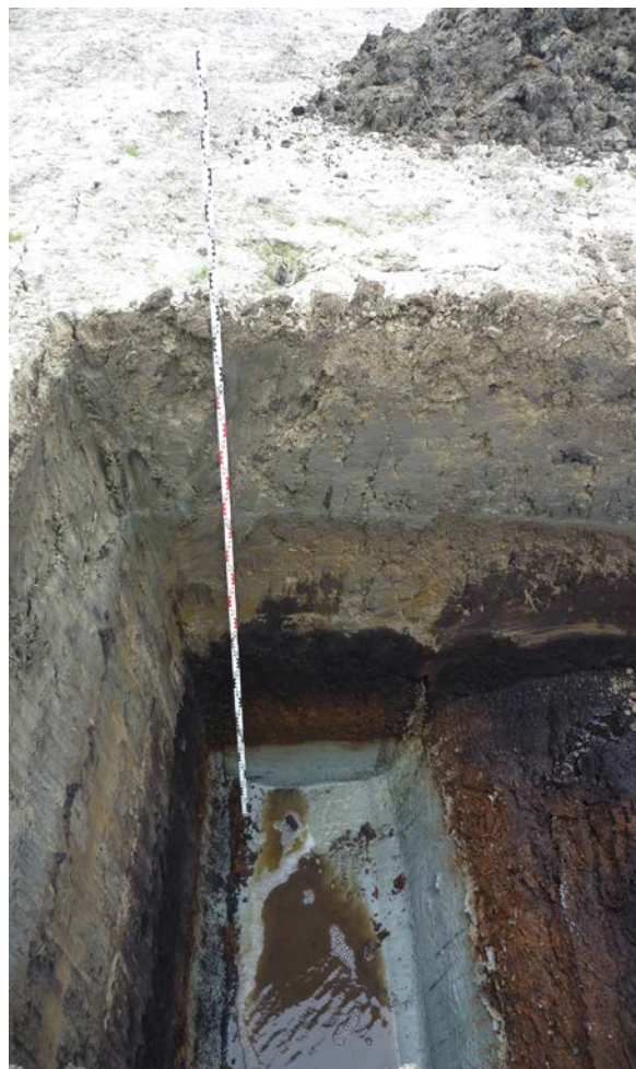
Fig. II - 4 Links een foto van het bodemprofiel van proefsleuf WP 3 met een recent verrommelde bovenkant, een dun pakket klei van het Laagpakket van Walcheren en een relatief dun pakket Hollandveen met veraarde top. Onderin de slappe klei van het Laagpakket van Wormer. Rechts een foto van het bodemprofiel van proefsleuf WP 7 met een bijna 80 cm dik pakket opgebrachte grond op de klei van het Laagpakket van Walcheren, daaronder een 60 cm dik pakket Hollandveen met veraarde top.
