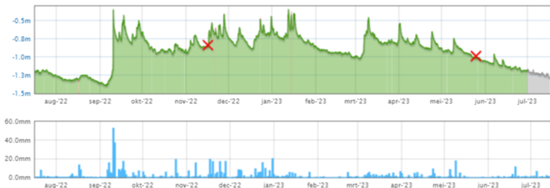
Figuur 3.4.1: Gemeten waterstanden door peilbuis (Gemeente Middelburg, 2023)
