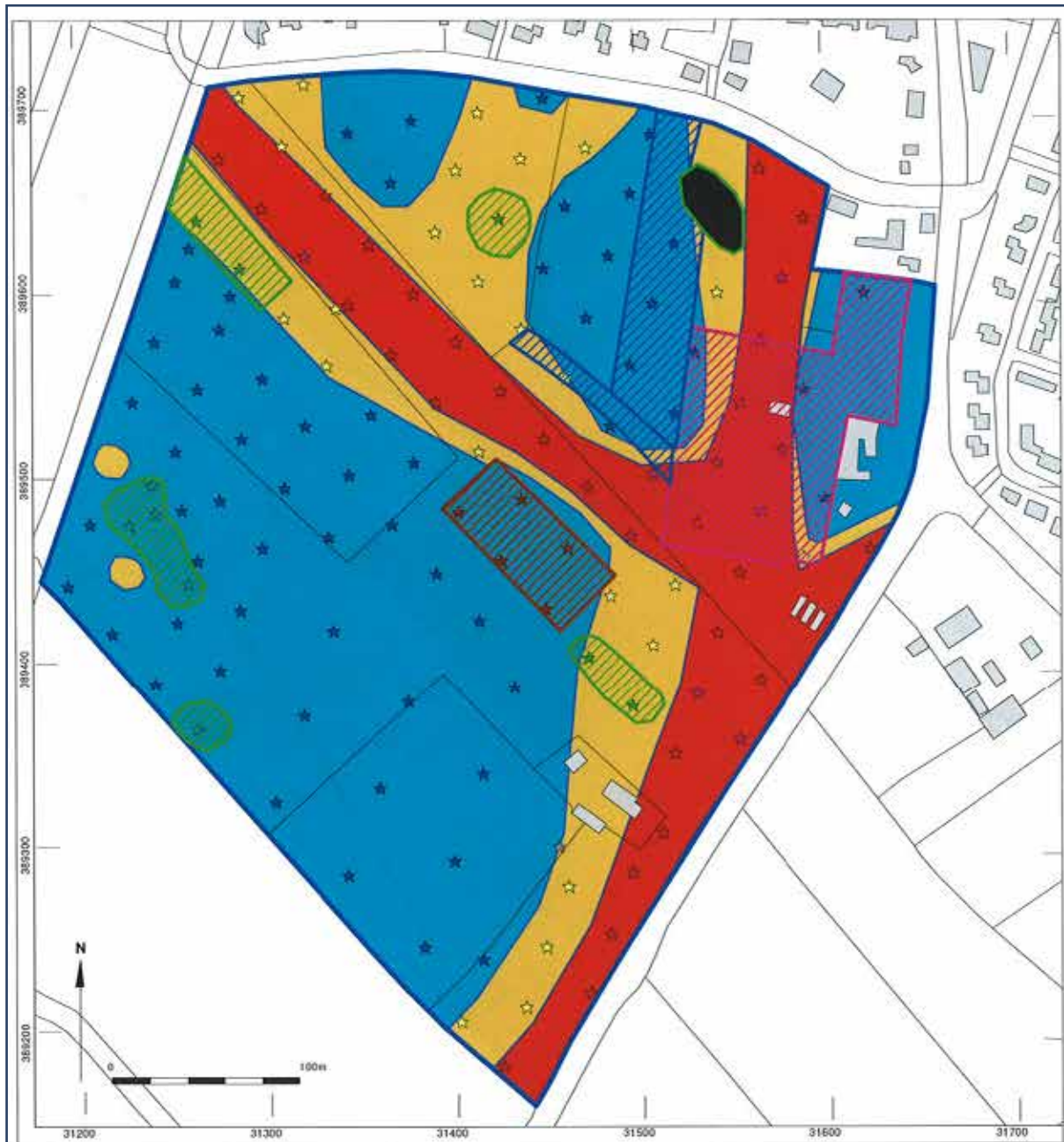
Fig. II - 4 Overzicht boorpunten ADC Archeoprojecten. Vergraven Hollandveen is blauw weergegeven, kreek geel en rood, intact Hollandveen groen gearceerd. De rood gearceerde zone geeft het Hof Essenvelt aan.
