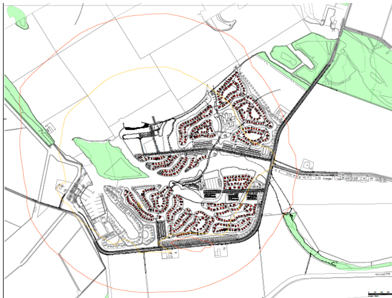
Figuur 7.23: Geluidcontouren 42 dB(A) (rood) en 47 dB(A) (geel) op 5 m hoogte op relevante deelgebieden van het Natuurnetwerk Zeeland door de geluidbelasting door heiwerkzaamheden in het westelijk deel van het plangebied (in de buurt van de Lemmerplaat).
