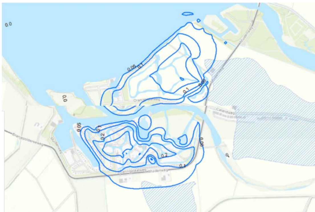
Figuur 7.15 Invloed aanleg oppervlaktewatersysteem met bodemweerstand 10 dagen (zoetwatervoorkomens zijn grijs gearceerd)
