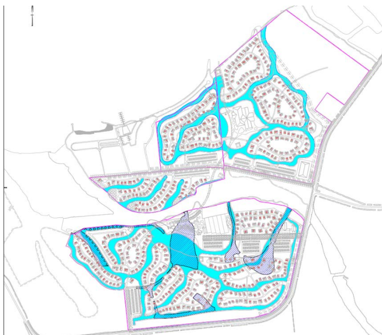
Figuur 6.11 Bestaande en nieuwe watergangen Waterpark Veerse Meer in geval van geen baanrotatie. De bestaande watergangen zijn weergegeven met donkerblauwe strepen en de nieuwe watergangen in lichtblauw. Op de locaties waar bestaande watergangen niet overlappen met de nieuwe watergangen zal oppervlaktewater worden gedempt.
