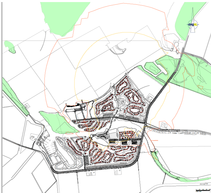
Figuur 7.24 Geluidcontouren 42 dB(A) (rood) en 47 dB(A) (geel) op 0,5 m hoogte op relevante deelgebieden van het Natuurnetwerk Zeeland door de geluidbelasting door heiwerkzaamheden in het oostelijk deel van het plangebied (in de buurt van De Piet).
