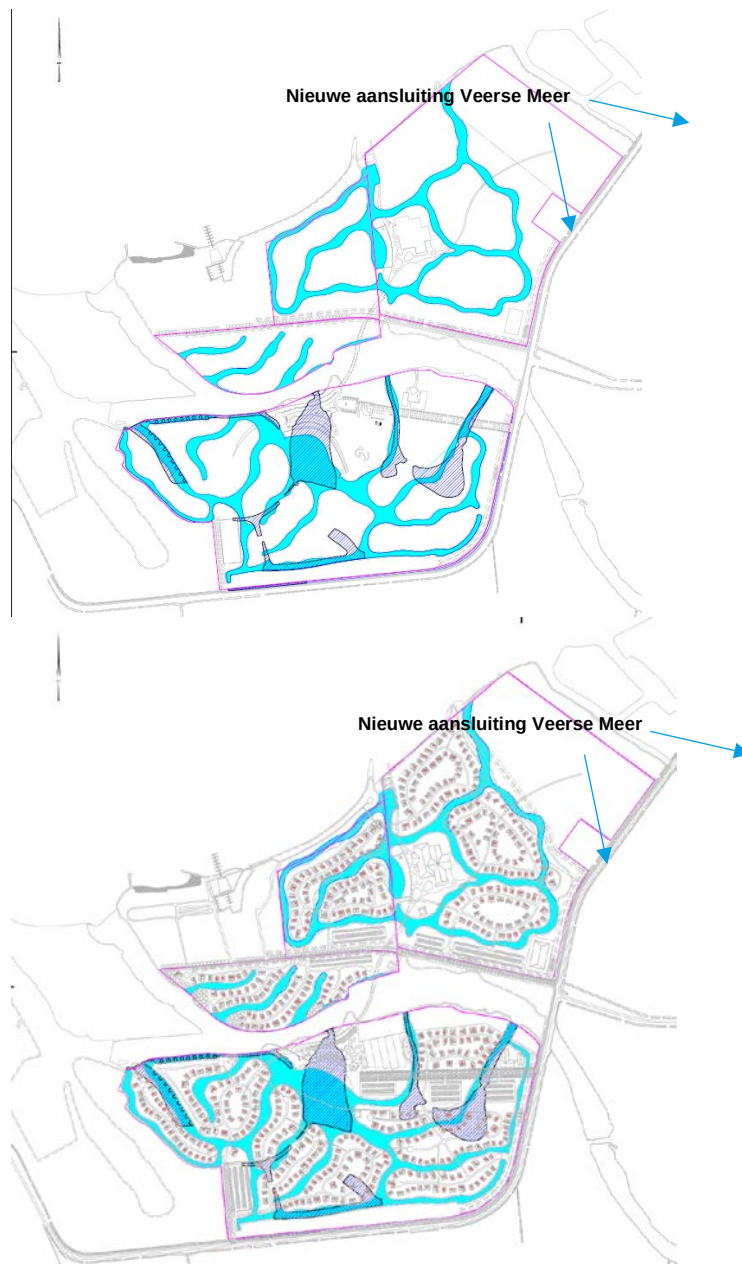
Figuur 2.5 Bestaande en nieuwe watergangen Waterpark Veerse Meer voor variant met baandraaiing (boven) en variant zonder baandraaiing (onder). De bestaande watergangen zijn weergegeven met donkerblauwe strepen en de nieuwe watergangen in lichtblauw. Op de locaties waar bestaande watergangen niet overlappen met de nieuwe watergangen zal oppervlaktewater worden gedempt. Pijlen geven aan waar twee nieuwe aansluitingen op het Veerse Meer komen.
