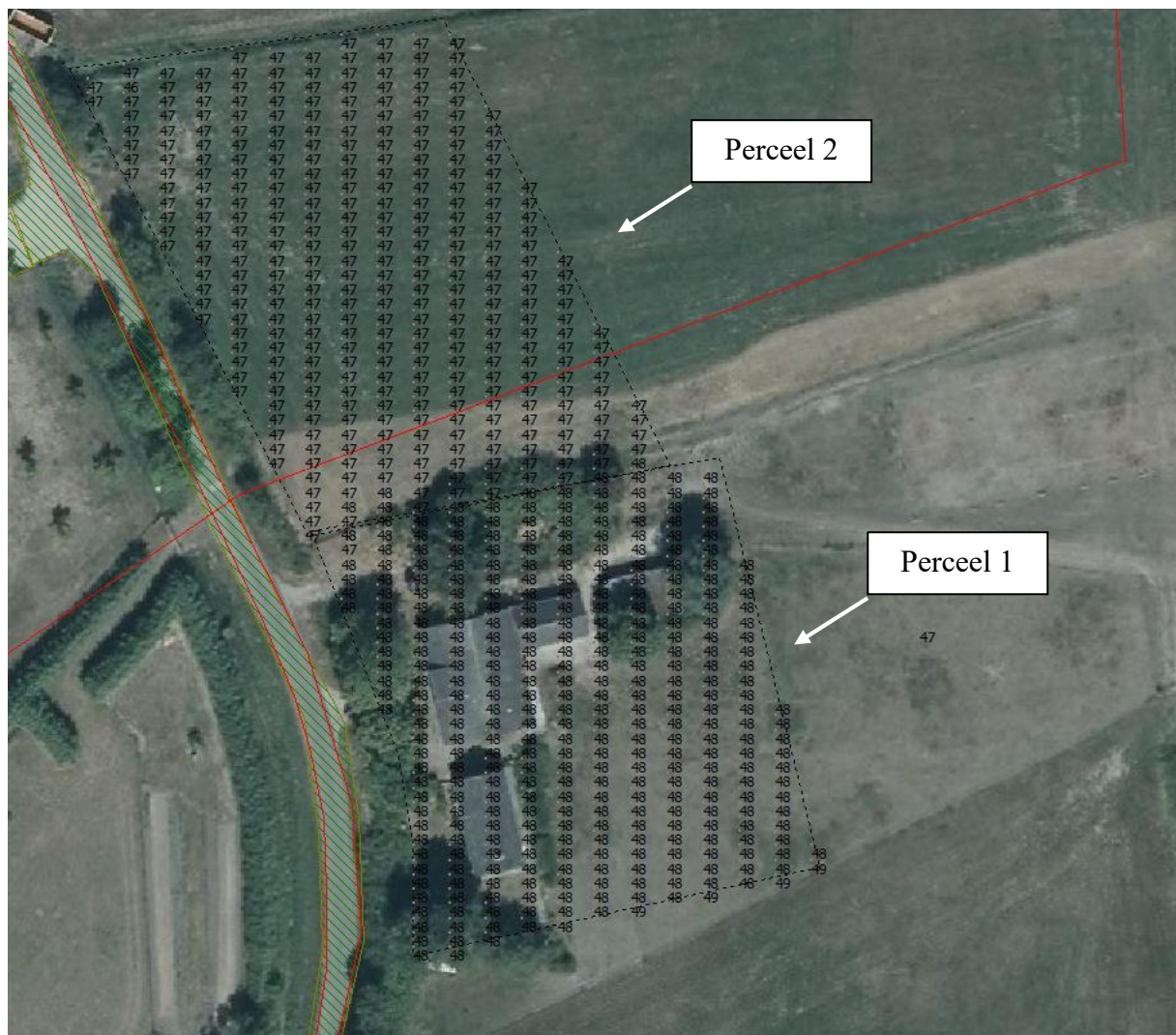
Figuur 2.2.2 Rekenresultaten industrielawaai in dB(A), toetsingshoogte 1,5 meter
