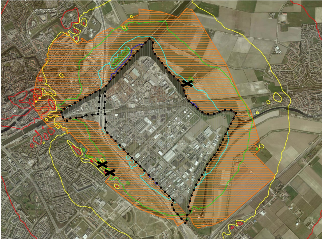
Figuur 4.2. Geluidscontouren van het gezoneerd industrieterrein Arnestein met bijbehorende geluidszone (bron: provincie Zeeland, etmaalwaarden)
