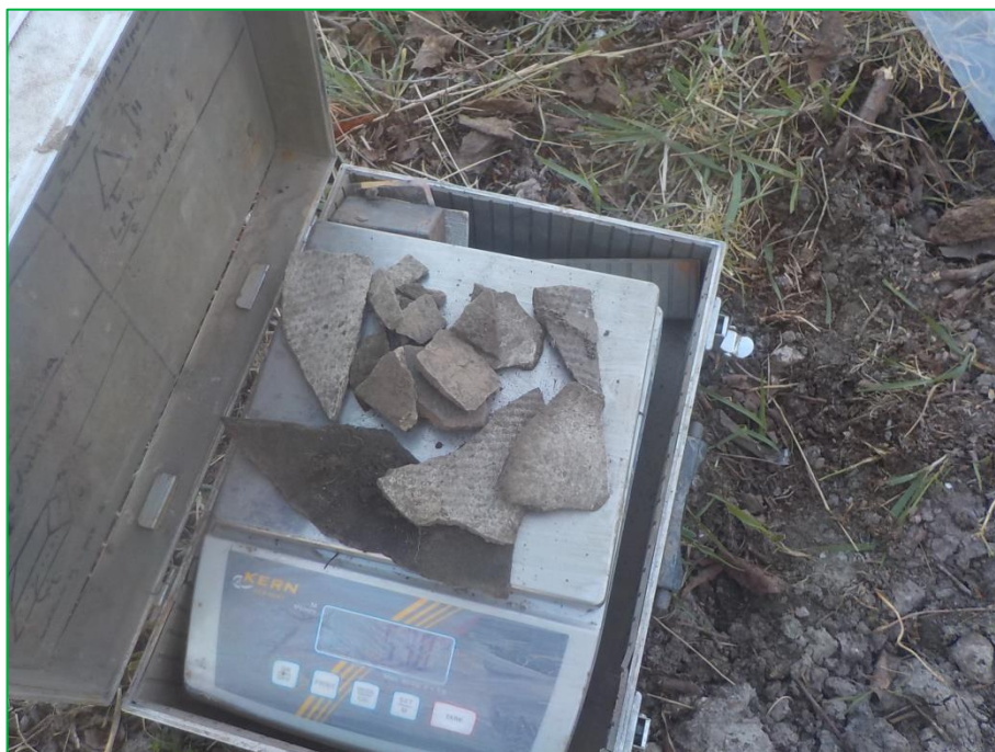
Foto 6. Verzamelde stukjes asbestverdacht materiaal tijdens 2 e maaiveldinspectie
