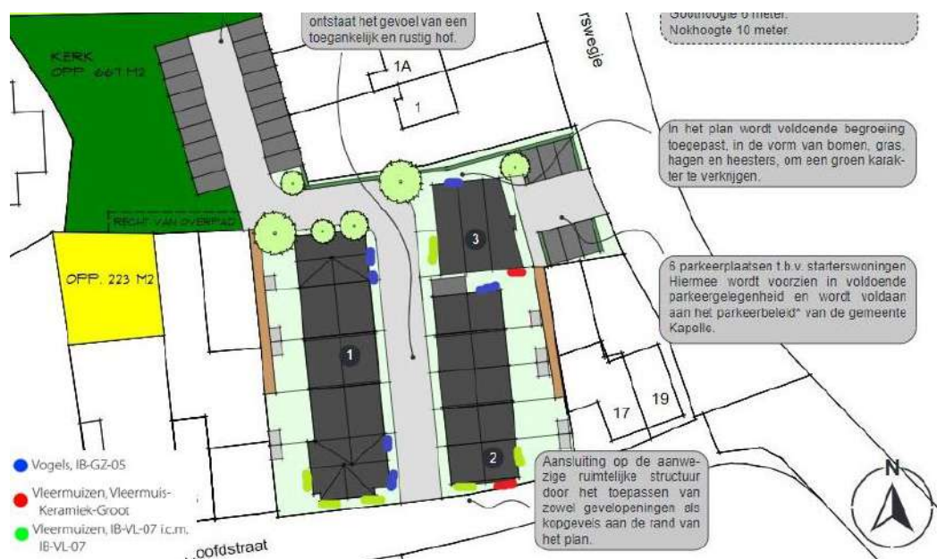
Figuur 2: Posities vleermuis- en vogelnestkasten en voorgestelde types. Alle kasten worden gerealiseerd kort onder de dakrand op de posities van de stippen. Kaartbron: opdrachtgever.
