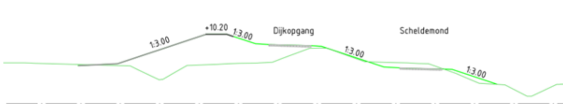
Afbeelding 2.15 Dwarsprofiel Slibdepot, met buitendijks de Voorhaven en binnendijks de Scheldemon
