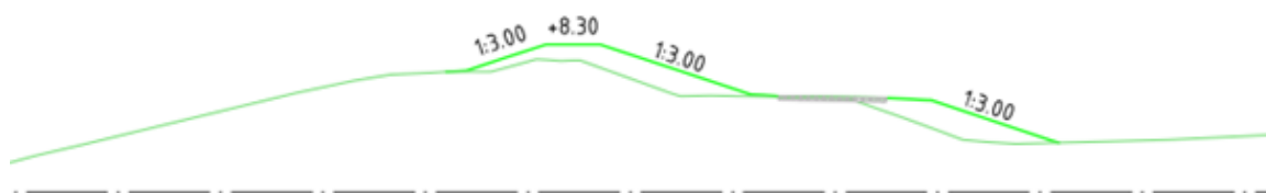
Afbeelding 2.13 Dwarsprofiel Kanaalzone - verhoogde binnenberm - dijkpaal 253-dijkpaal 256
