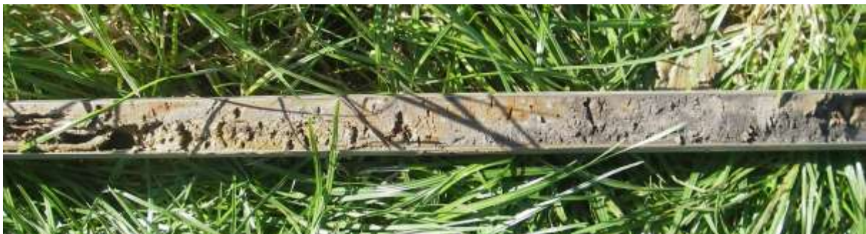
Figuur 19: Foto van de door zandlaagjes onderbroken klei (rechts) die in alle boringen onder de zwak humeuze klei (links) is aangetroffen.
