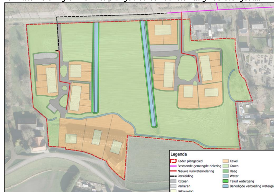
Figuur 9: Voorstel aansluitingen op gemengde riolering
