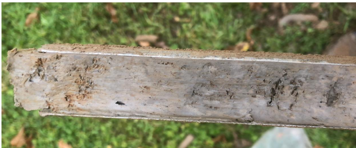
Detail van een laklaag in boring 3
