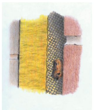
Figuur 7. Vleermuis hangt aan griplag op isolatiemateriaal
