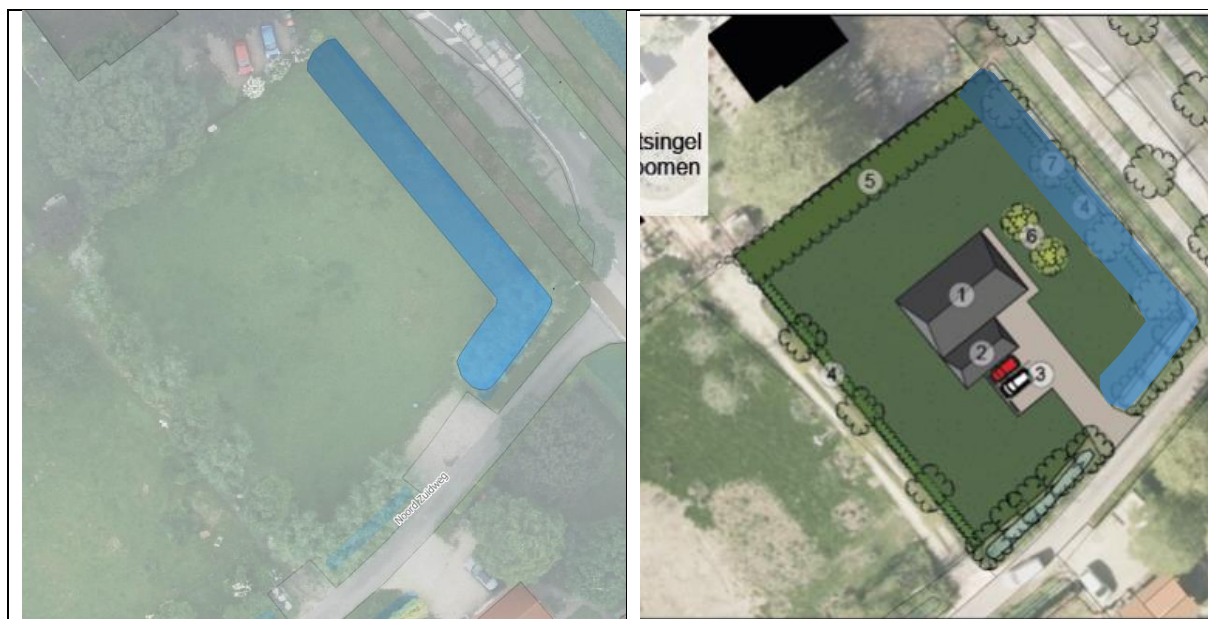
Afbeelding 1 Toekomstige waterberging binnen de locatie, geplot op de huidige (links) en toekomstige (rechts) situatie. De bestaande sloot aan de zuid- en oostzijde wordt verbreed en voorzien van een flauwe oever binnen de locatie. De sloot dient ruim 3 m te worden verbreed en zal aan weerszijden worden voorzien van een talud van 1:3.
