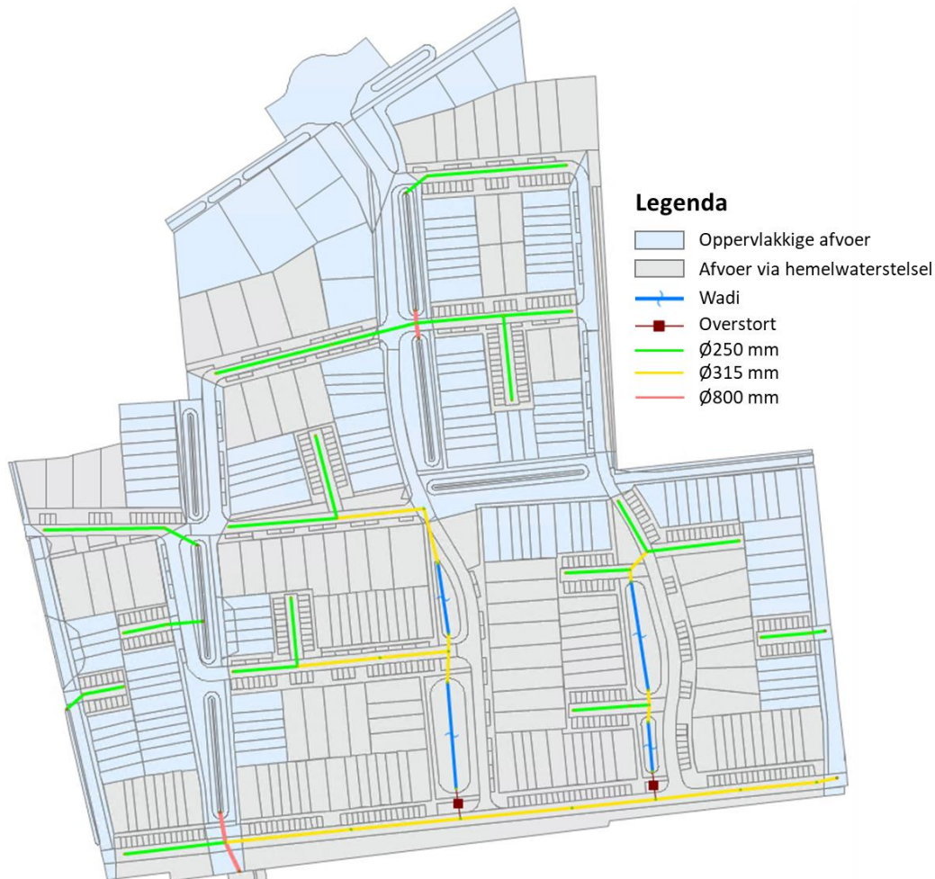
Figuur 4: Overzicht afwaterende oppervlakken en diameters hemelwaterstelsel
