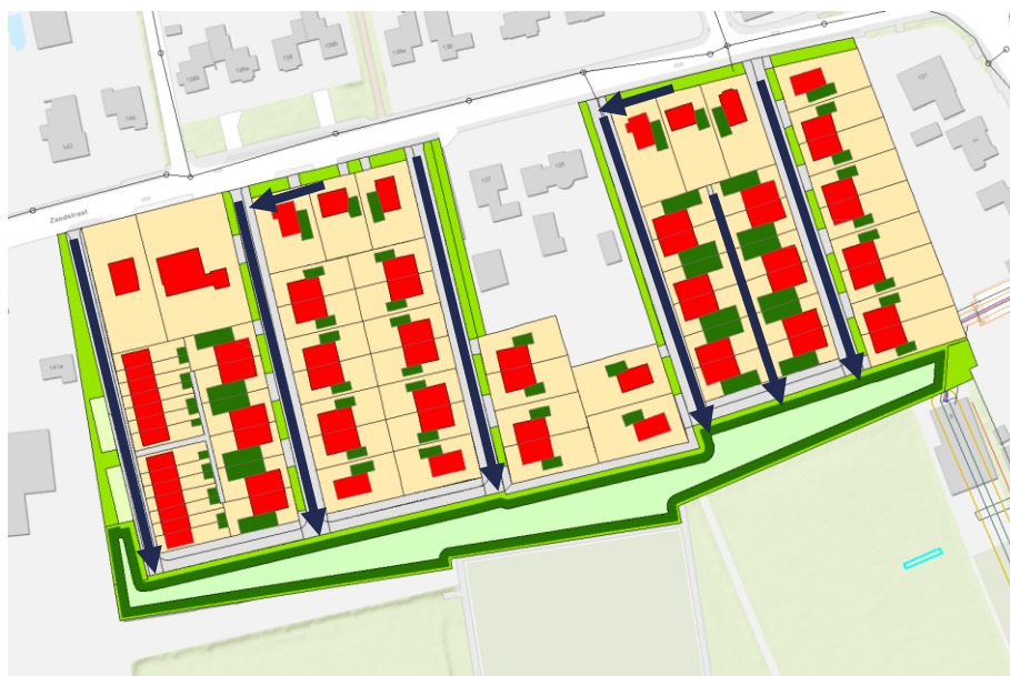
Figuur 7.5 Principe bovengrondse afvoer
