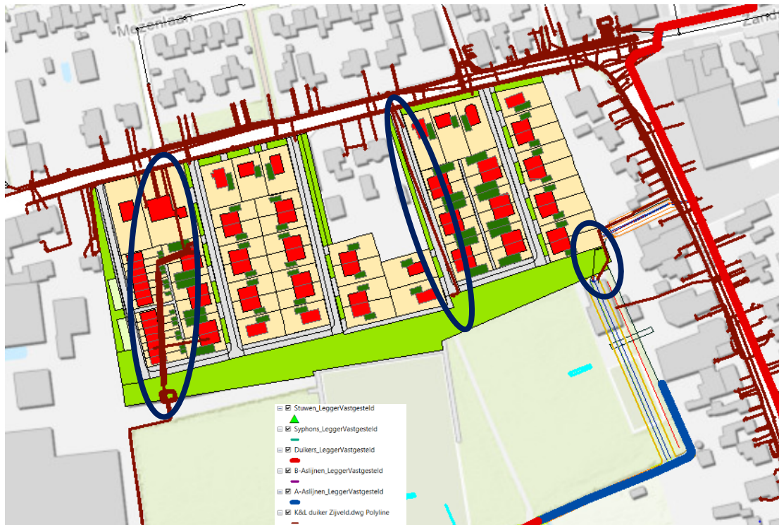
Figuur 2.3 Conflicten met bestaande kabels en leidingen.
