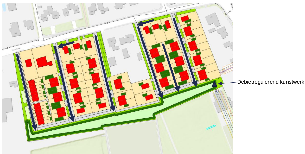
Figuur 6.5 Principe bovengrondse afvoer
