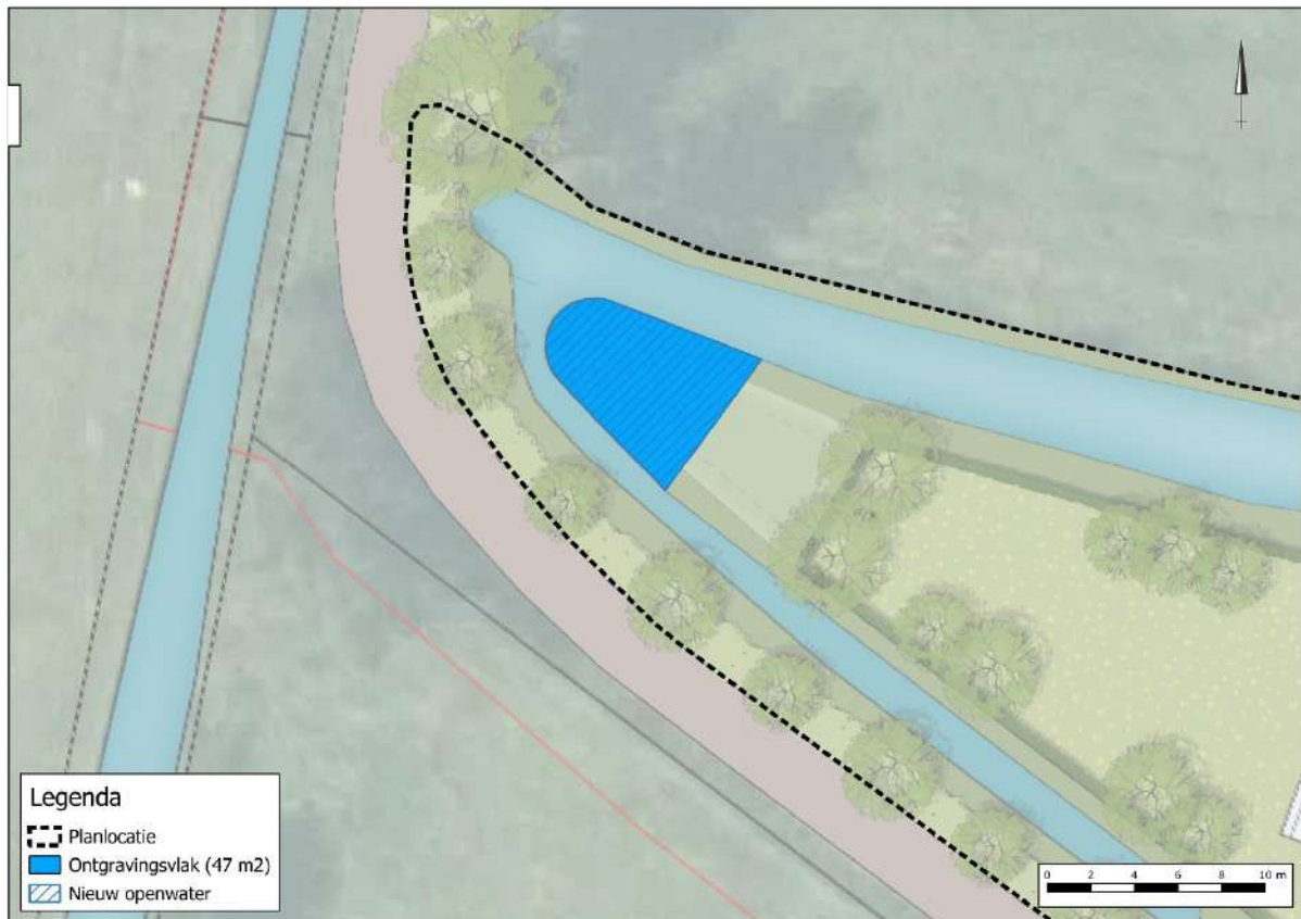
Figuur 5.3 Ontgravingsvlak en aanleg nieuw openwater (indicatief)
