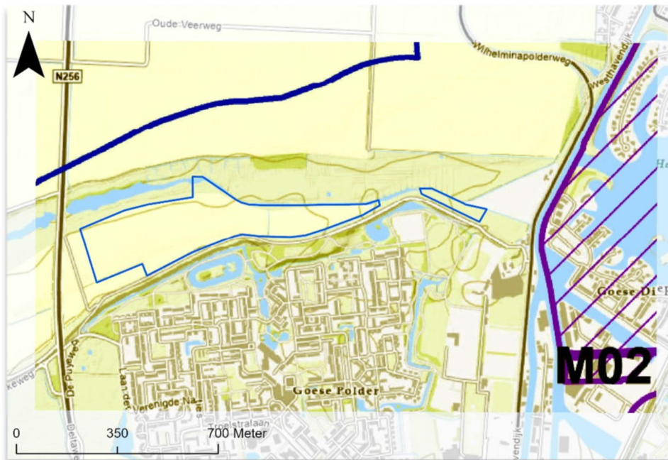
Afbeelding 3 Uitsnede van de OO-bodembelastingkaart van het reeds uitgevoerde gemeentebrede vooronderzoek OO van gemeente Goes. Te zien is dat het onderzoeksgebied onverdacht is verklaard op OO. Direct ten oosten van het Havenkanaal is een verdacht gebied (M02) afgebakend. Er zijn geen verdere gegevens over dit verdachte gebied bekend.
