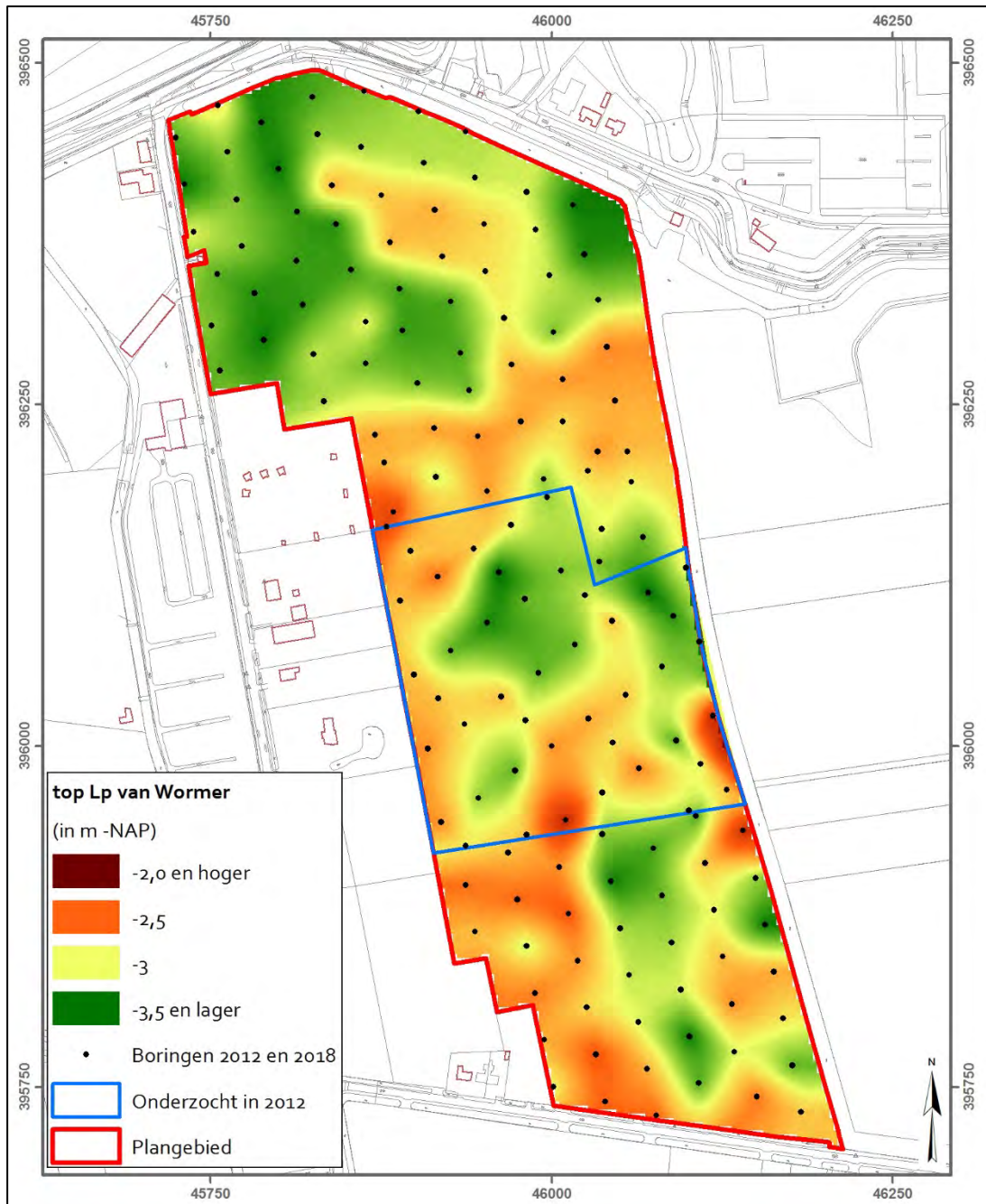
Afbeelding 31 Weergave van de diepteligging van de bovenzijde van het Laagpakket van Wormer in de boringen uit zowel het onderzoek uit 2012 als 2018. Schaal: 1:5.000.
