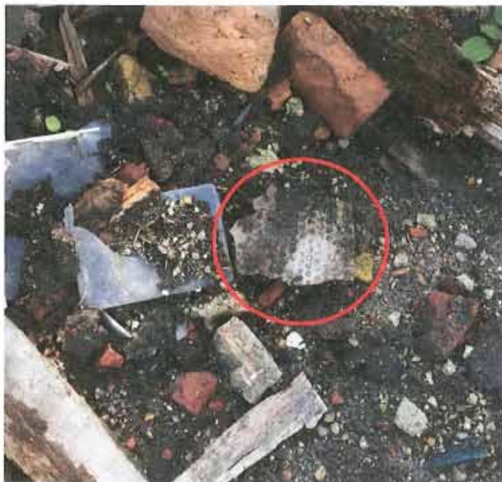
Asbestverdacht materiaal op het maaiveld
