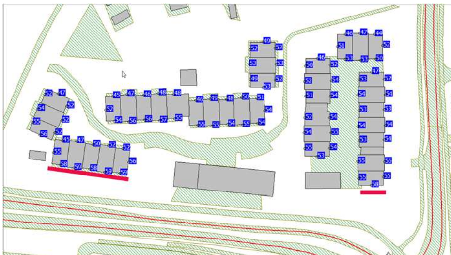
Figuur 3 Op de gevels langs de rode lijn wordt de maximale ontheffingswaarde ten gevolge van de A58 overschreden
