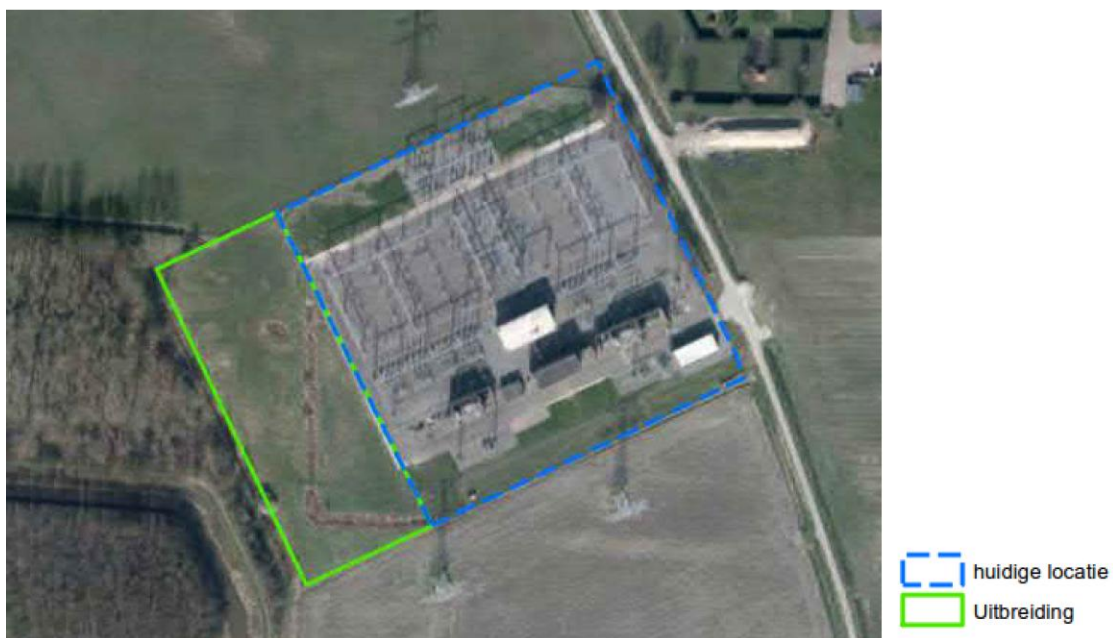
Figuur 2.5 Uitbreiding 150 kV-station Goes de Poel
