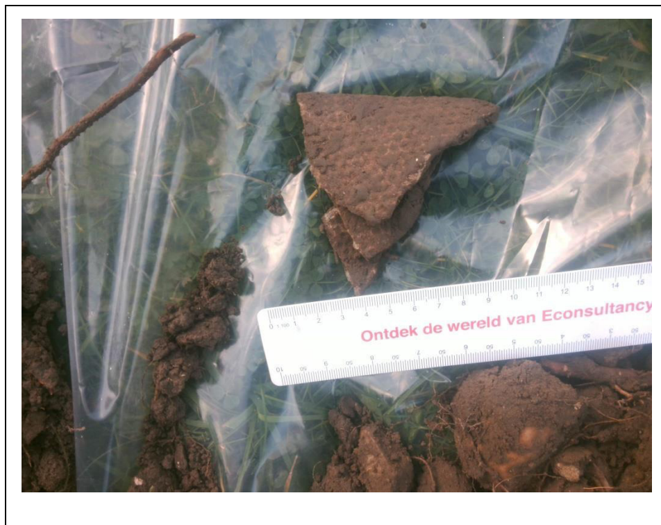
Asbestinspectiegat materiaal C03.
