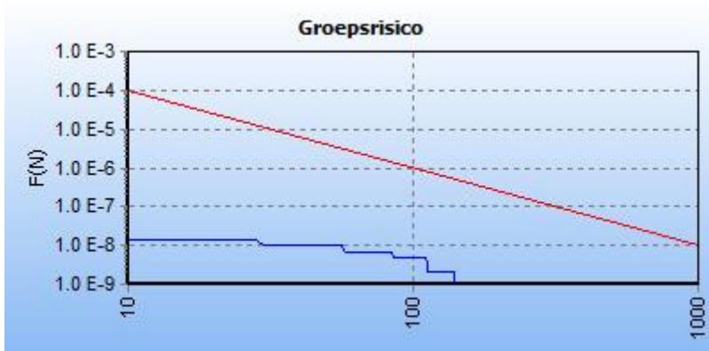
5.2 Figuur 5.2 FN curve voor 6657_leiding-Z-567-23-deel-1 van N.V. Nederlandse Gasunie voor de kilometer tussen stationing 1740.00 en stationing 2740.00
