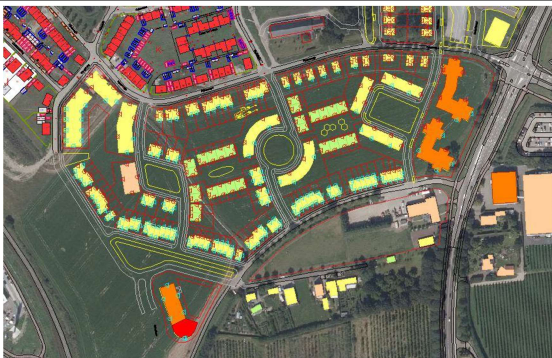
Figuur 27: Overschrijding van de geluidbelasting als gevolg van de A58. De blauwe toetspunten geven weer waar de overschrijding van de voorkeursgrenswaarde plaatsvindt
