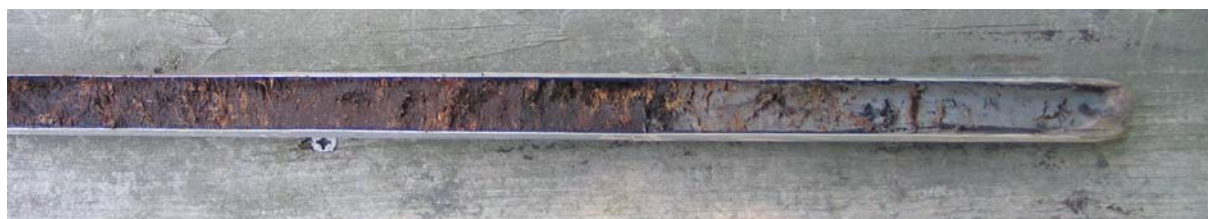
Figuur 12: Guts kern van boring 29 met klei (rechts) onder het veen (links)
