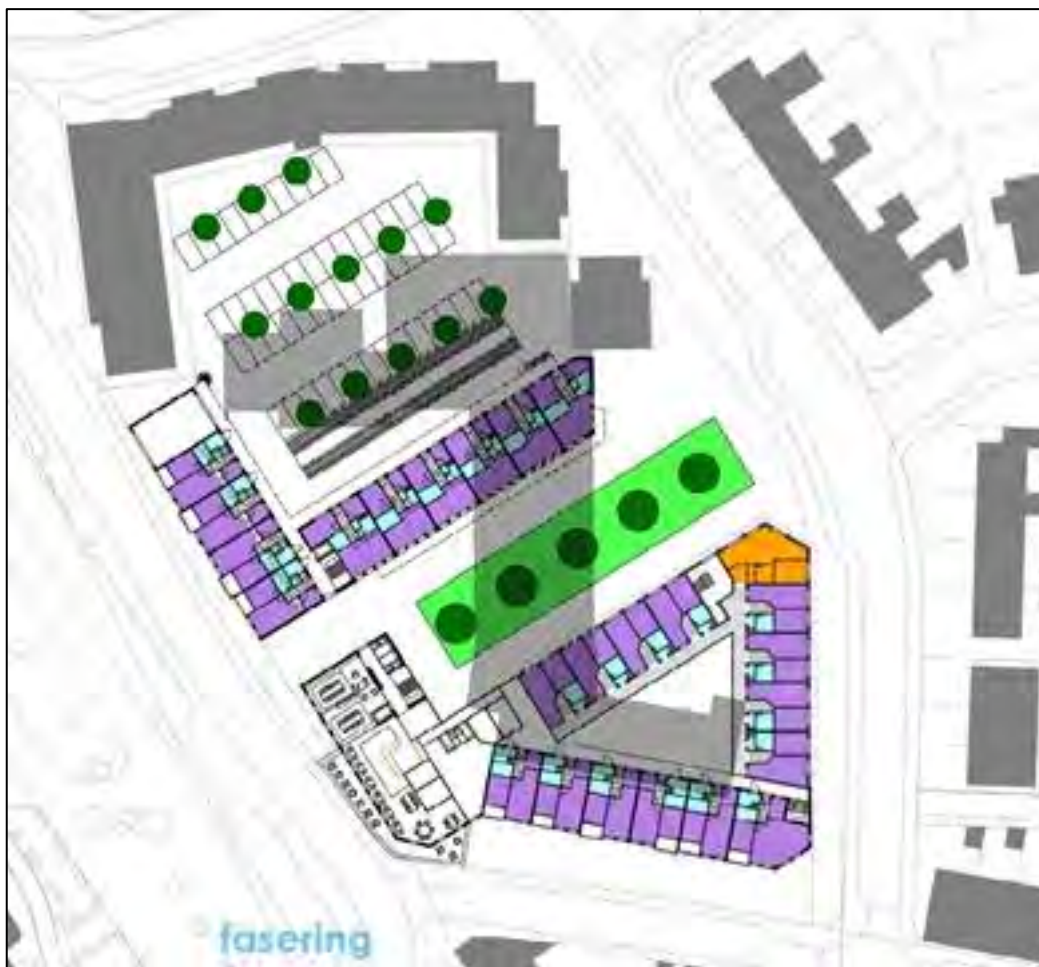
Afbeelding 4 Ontwerpplan van de toekomstige situatie (gekleurd). De bestaande te slopen bebouwing is lichtgrijs weergegeven, de overige bestaande (en te handhaven) bebouwing is donkergrijs weergegeven. Zie ook bijlage 1. Bron: opdrachtgever.
