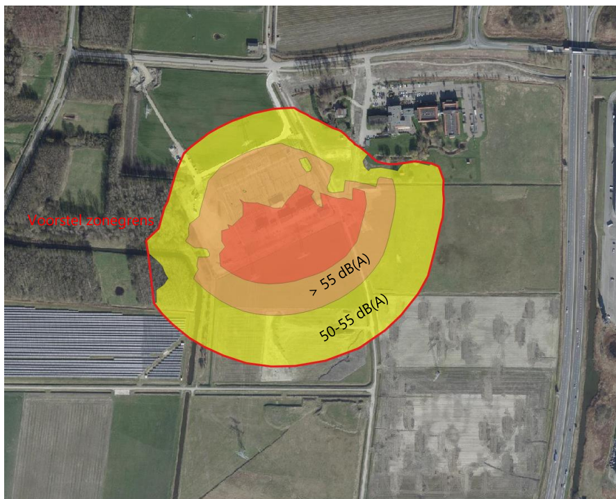
f 6.1 Voorstel zonegrens transformatorstation Goes De Poel
