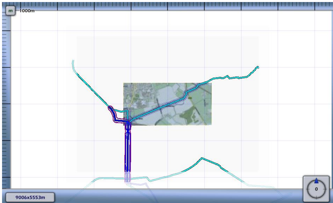
3.3 Figuur 3.6 Plaatsgebonden risico voor 7290_leiding-Z-567-23-deel-1 van N.V. Nederlandse Gasunie
