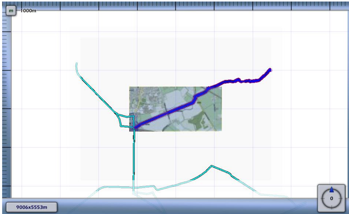
3.3 Figuur 3.6 Plaatsgebonden risico voor 7290_leiding-Z-567-23-deel-1 van N.V. Nederlandse Gasunie
