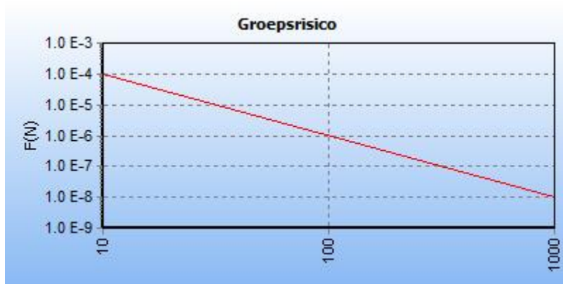
5.2 Figuur 5.5 FN curve voor 7290_leiding-Z-567-12-deel-1 van N.V. Nederlandse Gasunie voor de kilometer tussen stationing 0.00 en stationing 1000.00
