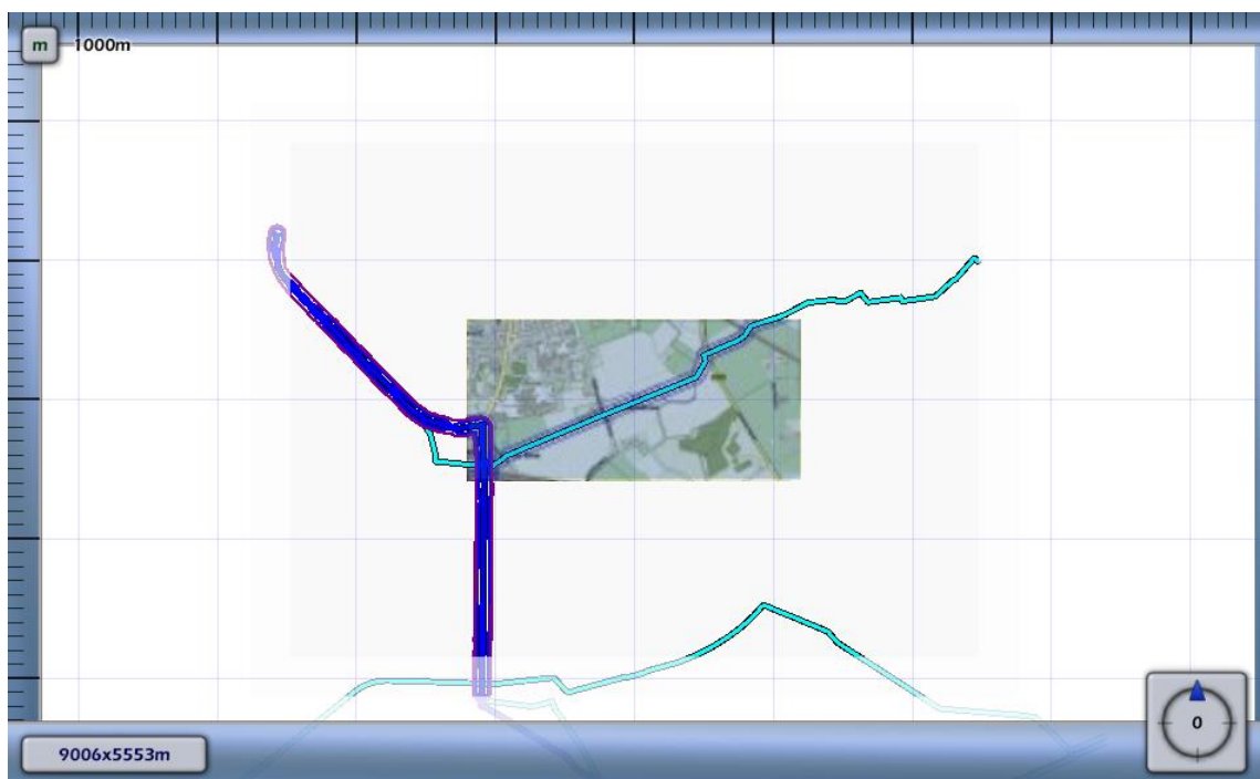
3.1 Figuur 3.4 Plaatsgebonden risico voor 7290_leiding-Z-567-05-deel-1 van N.V. Nederlandse Gasunie
